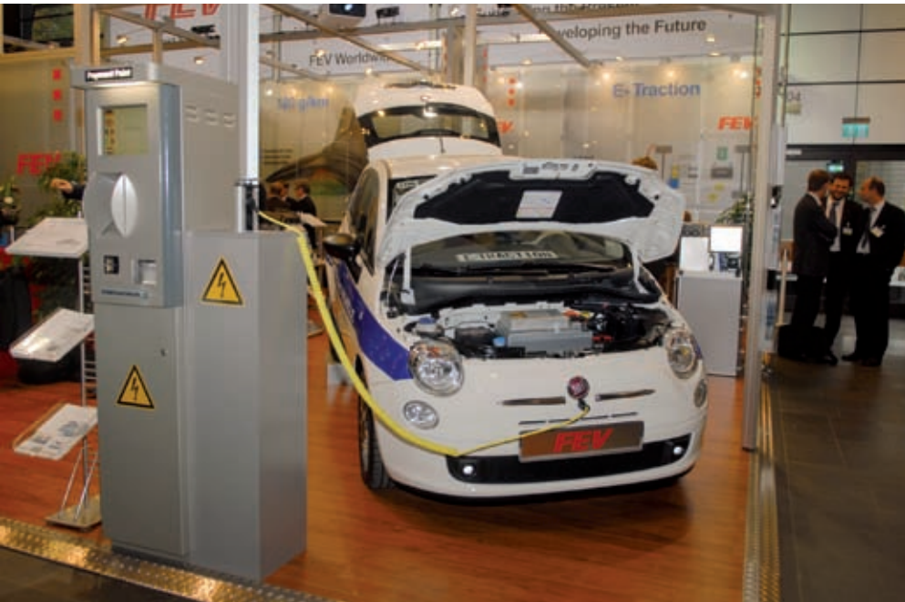
Die FEV hat ein Elektrofahrzeug mit Range Extender auf Basis des Fiat 500 entwickelt
